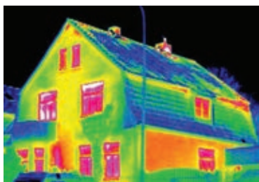
exemple d'étude thermographique: les parties en rouge signalent les ouvrages déperditifs
